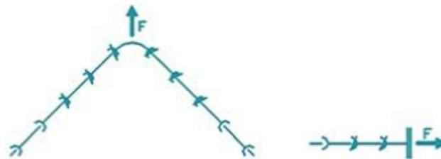
برای تعیین طول مهارشونده توسط لوله با اتصال مقاوم به زلزله در فشار تست ۱۰ بار و با خاک دارای استحکام متوسط و ضریب اطمینان ۱/۲ می‌توان از جدول زیر استفاده کرد. در مورد اتصالات زانویی باید هر دو طرف زانویی با این طول توسط لوله با اتصال مقاوم به زلزله مهار شوند.
