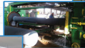
۷. تست هیدرواستاتیک تمامی لوله‌های تولیدی
