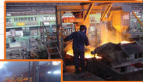
۴. شارژ ذوب داخل ماشین لوله‌ریزی
