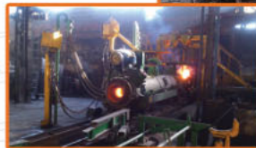
۵. ریخته‌گری گریز از مرکز به شکل یکپارچه
